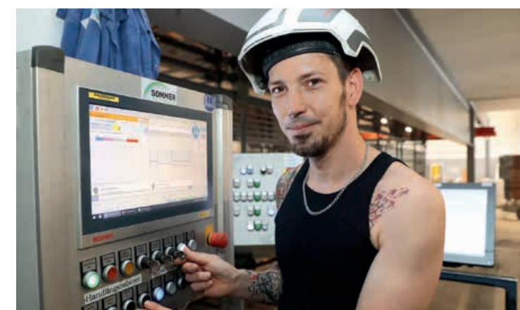
Christian Harp ist Maschinenführer bei den Schalungselementen. Er sorgt dafür, dass Aussparungen für Fenster und Elektroinstallationen frei bleiben.
