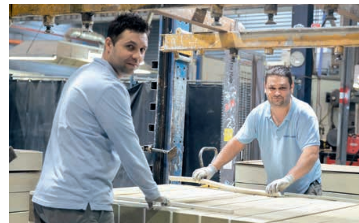
Ivan Bartosch und Laszlo Sey ordnen die gebrannten Waben zu großen Paketen, die in die Abgasreinigungsanlagen eingebaut werden.
